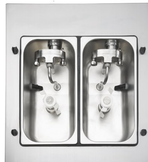
BOMBA DE AIRE Y AGITADOR EN LA CUBA
